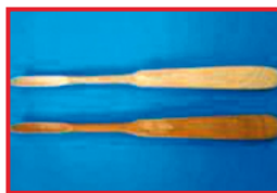
Sonda cava di guida; superficie come nuova: lucida-marrone medio sbiadita: opaca-bianco candeggiato
