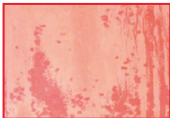
Alterazione ottica di alluminio anodizzato già in presenza di alcalinità tenue
