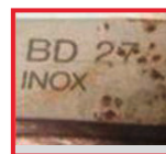
Pinzetta con corrosione perforante. Causa: il sovrainvecchiamento del nastro con funzione di codifica comporta il passaggio di sostanze dannose contenenti cloruri.
