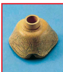
Fessura da invecchiamento su una maschera respiratoria
