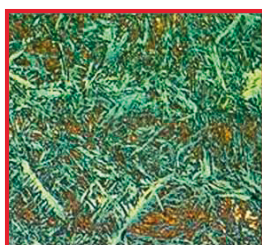
Morsura - microstruttura martensitica dell'acciaio inossidabile degli strumenti - temprato (immagine ingrandita al 500%)
