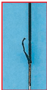
Isolamento danneggiato su uno strumento ad alta frequenza
