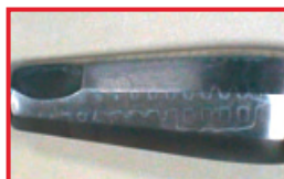
Impugnatura cava con presenza visibile di residui
