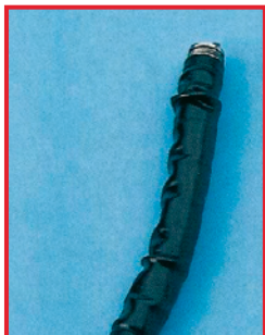
Rigonfiamento all'estremità distale di un fibroscopio
