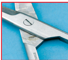
Corrosione da sfregamento per mancata lubrificazione
