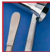
Conseguenza: strumenti che presentano residui di calcare
