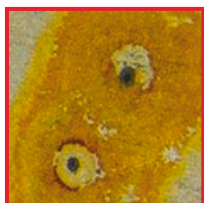
L'utilizzo di sale rigeneratore contenente cloruro ha comportato una massiccia corrosione perforante sulla superficie degli strumenti. Causa: collegamento non a tenuta dello scambiatore a ioni negli apparecchi di lavaggio e disinfezione.
