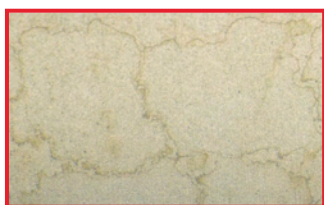
Esempio di macchie dovute ad impurità nel vapore di condensa
