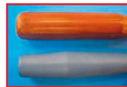
Possibile sostituto per Harex: PEEK o PPSU
