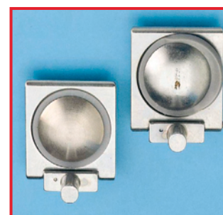
Destra: valvola di un trequarti non a tenuta a causa del rigonfiamento della guarnizione in seguito a contatto con dell'olio. Sinistra: valvola nuova
