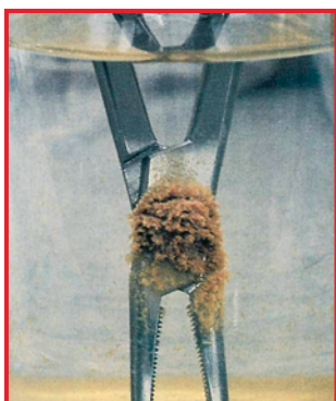
Formazione di ruggine dopo immersione prolungata in soluzione fisiologica di NaCl
