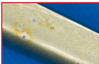
Corrosione perforante indotta da cloruri su uno strumento
