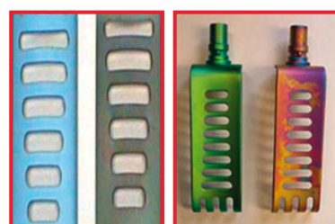
Sezione – lame in titanio: Valvola sx – nuova di fabbrica. Valvola dx – pulita in modo meccanico. Il più delle volte i cambiamenti di colore sono uniformi. Talvolta però si presentano sotto forma di macchie/macchie multicolore.
