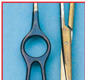
Scolorimenti su strumenti dovuti ad acido silicico
