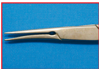
Deformazione in seguito a trattamento inadeguato
